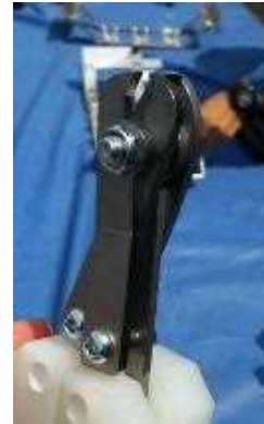
PDカッターを改良し、 1本の工具で切断しつつ把持
