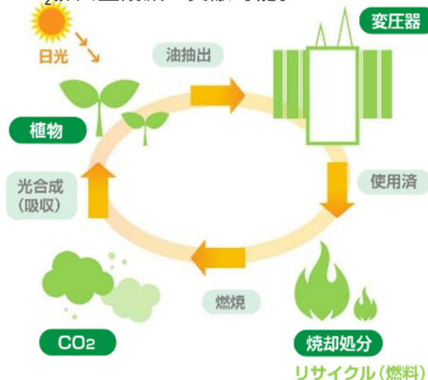
植物油（パームヤシ）を使用した電力用変圧器 〔岩富変電所（千葉県佐倉市）〕
