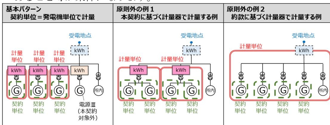
kWh …託送供給等約款に基づく計量器 (発電量調整契約の精算用)
