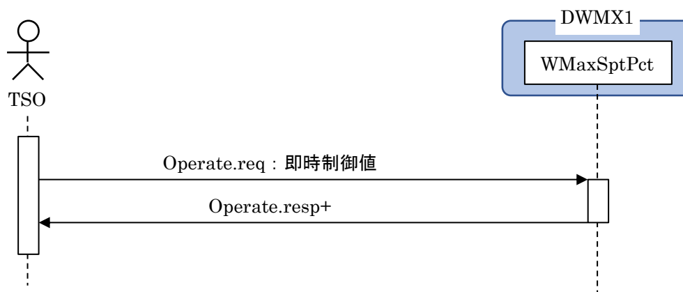
図10 即時制御を行う場合の通信手順
