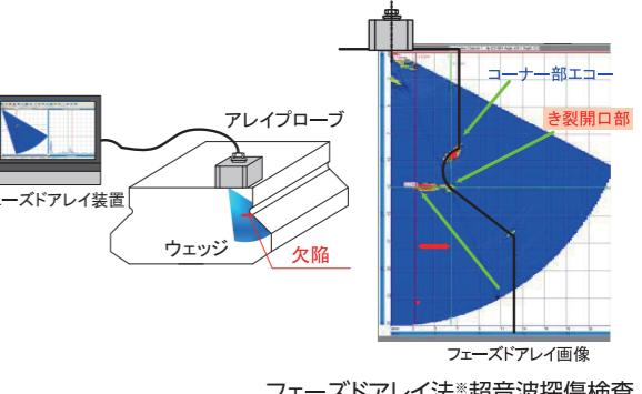
フェーズドアレイ法\*超音波探傷検査
