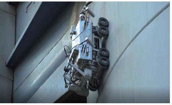
多目的鋼板厚さ測定ロボット
