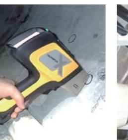
非破壊の塩化物イオン量測定
