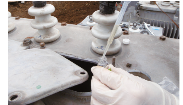
トランス内絶縁油採取：絶縁油中PCB分析
