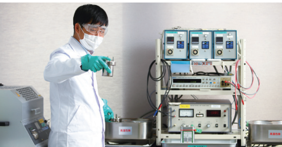
絶縁油分析／劣化診断
