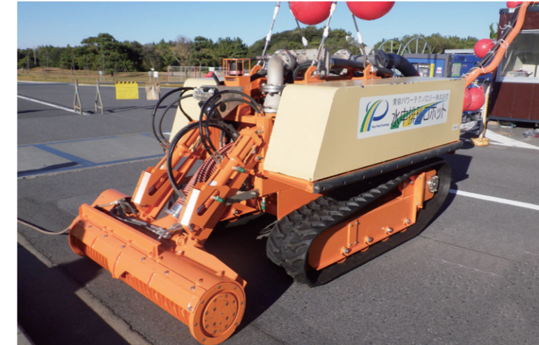
水中排砂ロボット
