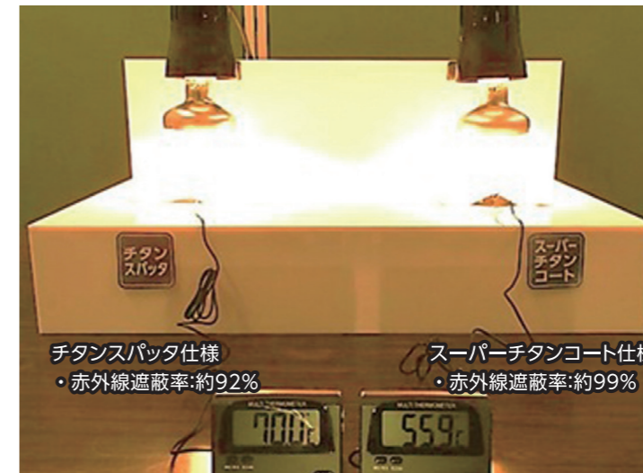
チタンスパッタ仕様 ・赤外線遮蔽率:約92% スーパーチタンコート仕様 ・赤外線遮蔽率:約99% チタンスパッタ仕様に比べてスーパーチタンコート仕様の方が約14℃低減 ※メーカー調べ
