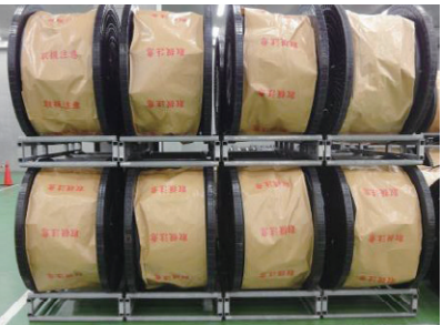
電線ドラム用パレットを活用した再生プラスチックドラムの保管方法
