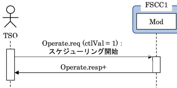
図 10 スケジュール制御に戻る際の通信手順
