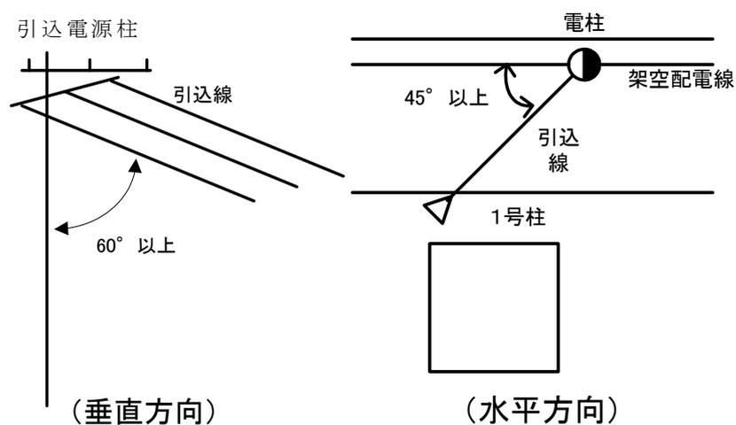
(b) 引込線が隣接地の敷地内を通過しない位置を標準として選定していただきます。
