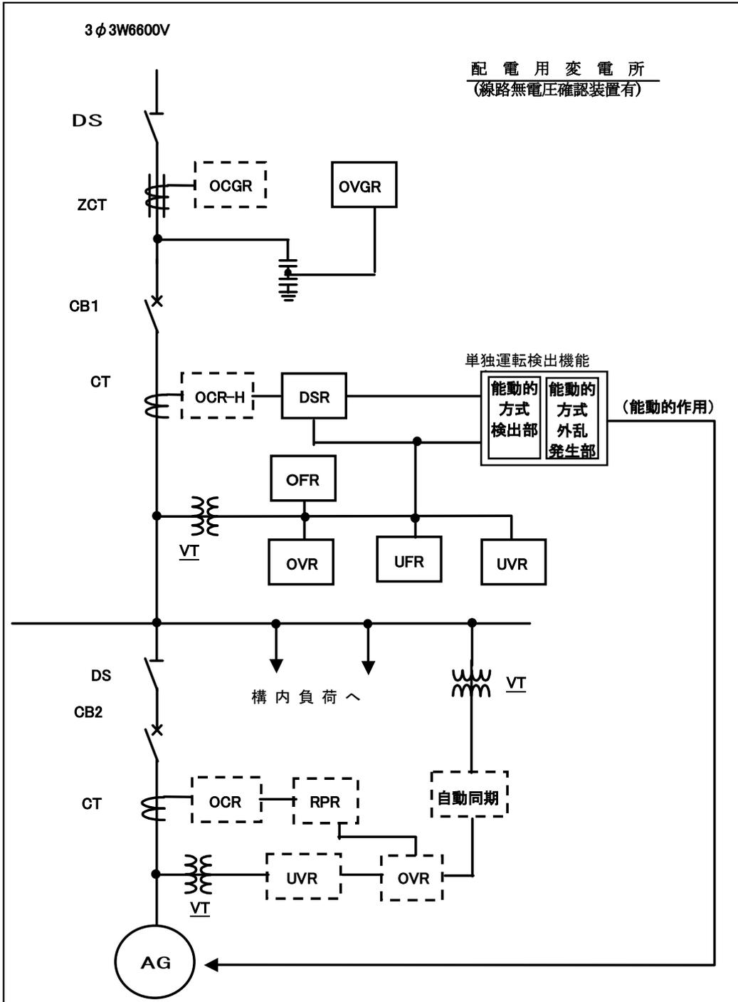
(参考 4) 逆変換装置を用いた発電設備を連系し、能動的方式を含む二方式以上の単独運転検出機能を適用した場合の連系設備構成例
