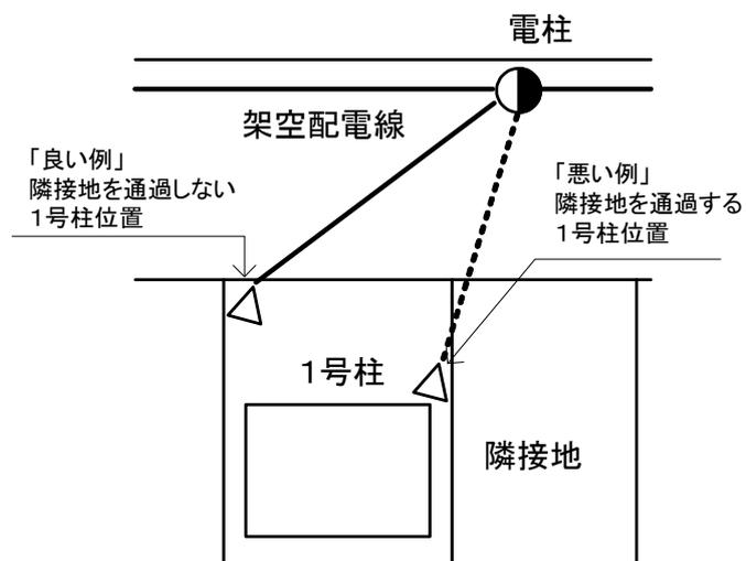
(c) 当社の電柱から引込柱まで 3m 以上の距離が確保できる位置を標準として選定していただきます。ただし, 特例需要場所と非特例需要場所でお客さま引込柱を共用する場合には, 接続スペースが必要となるため 4m 以上の距離を確保していただきます。
