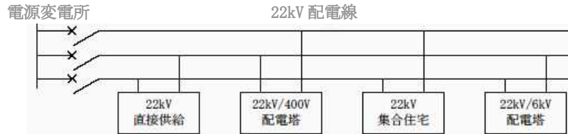
第Ⅲ－4図 22kV 本線・予備線方式の形態
