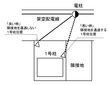
(c) 当社の電柱から引込柱まで 3m 以上の距離が確保できる位置を標準として選定していただきます。ただし、特例需要場所と非特例需要場所でお客さま引込柱を共用する場合には、接続スペースが必要となるため 4m 以上の距離を確保していただきます。
