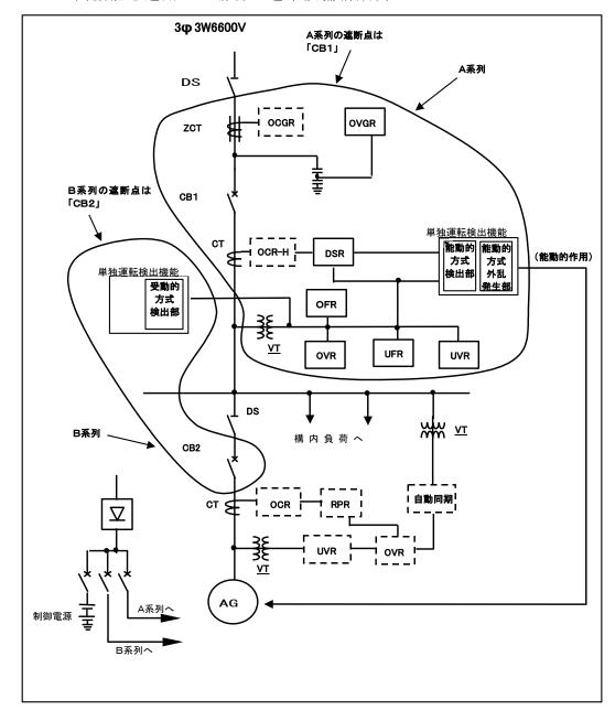
(参考 4) 逆変換装置を用いた発電設備を連系し、能動的方式を含む二方式 以上の単独運転検出機能を適用した場合の連系設備構成例
