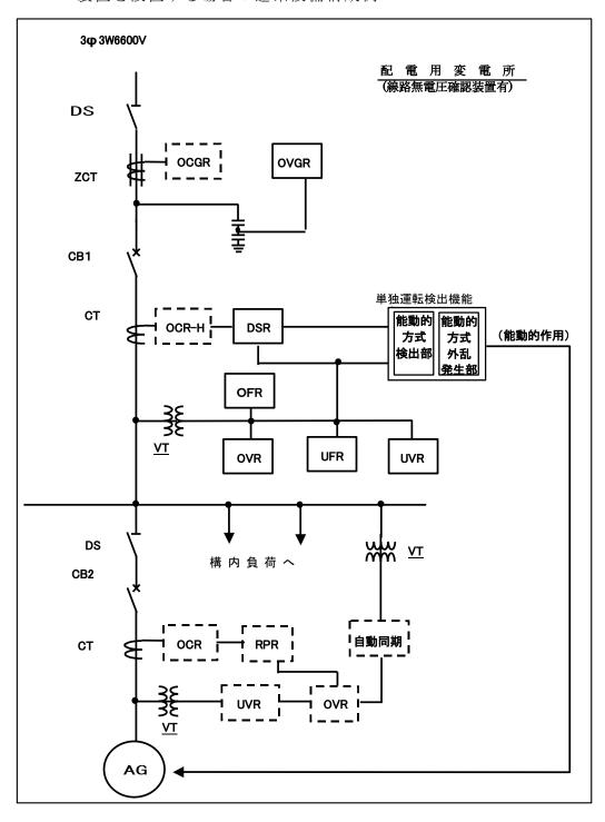
(参考 3) 同期発電機を連系し、能動的方式を含む二方式以上の単独運転検 出機能を適用した場合の連系設備構成例
