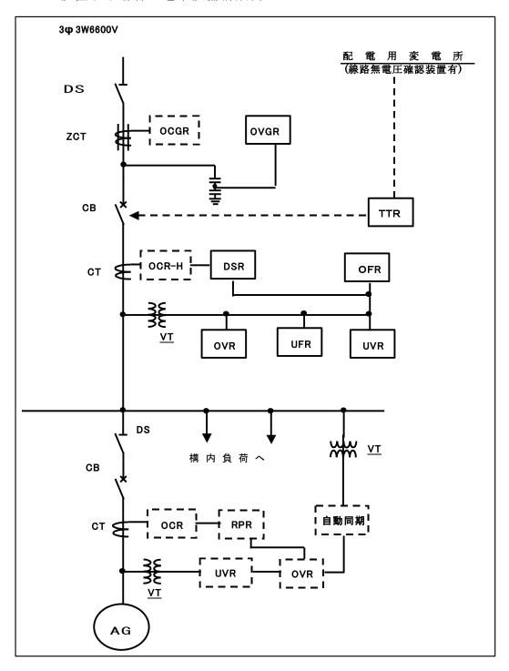
(参考 2) 同期発電機を連系し,単独運転検出機能を適用し線路無電圧確認 装置を設置する場合の連系設備構成例
