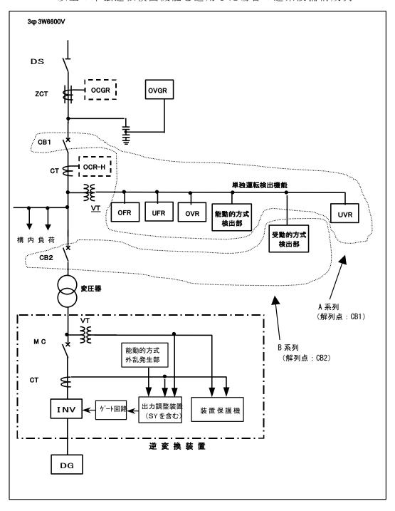
(参考 5) パワーコンディショナ (PCS) を用いた発電設備を連系し、能動的方式を含む二方式以上の単独運転検出機能を適用した場合の連系設備構成例
