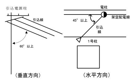
(b) 引込線が隣接地の敷地内を通過しない位置を標準として選定していた だきます。
