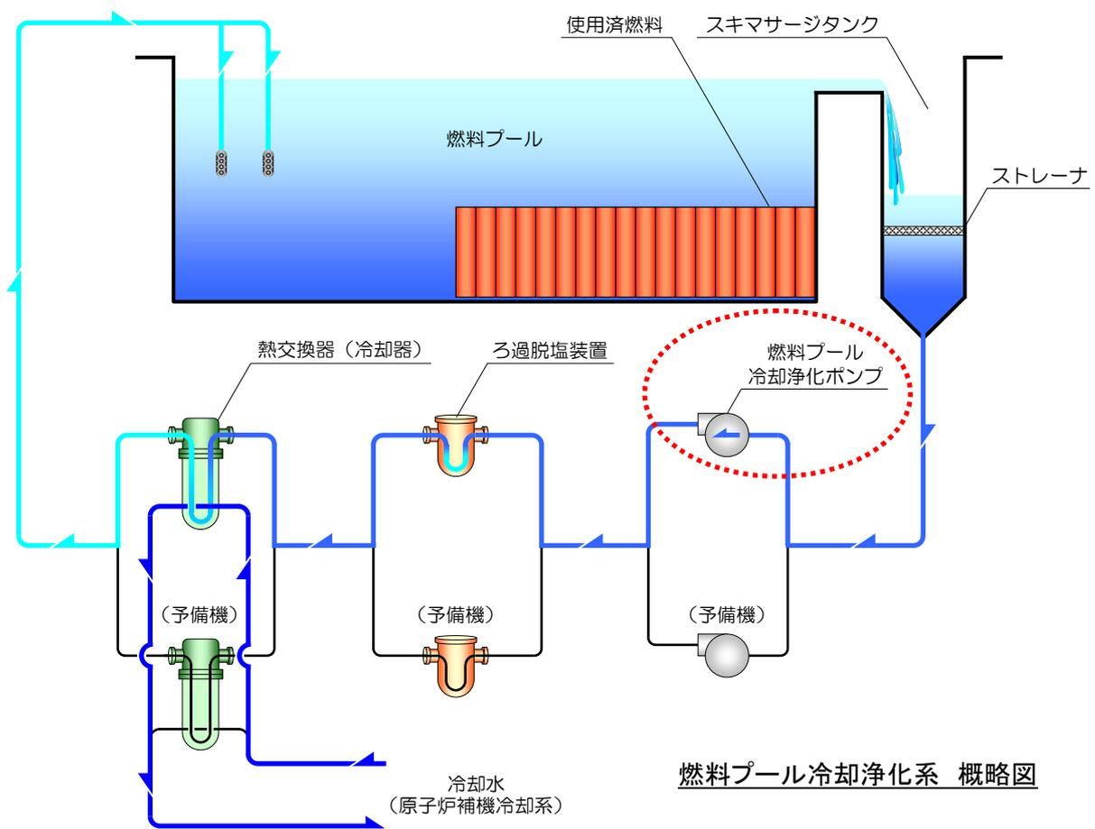
燃料プール冷却浄化系 概略図
