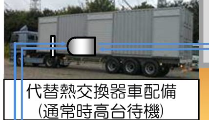
代替熱交換器車配備 (通常時高台待機)
