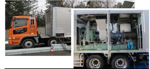
ガスタービン発電機車 (高台配備)
