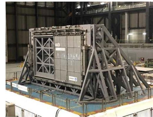
図9 オペフロBOP閉止装置加振試験状況
