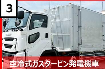
軽油の燃焼ガスでタービンを回して電気を作る発電機を搭載し、大型の冷却設備を運転できる電源を確保。津波の影響を受けない場所に配備。
