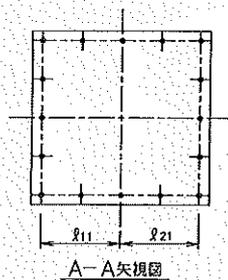
$$\text{基礎ボルトに作用する引張力 : } F_b = \frac{m_1 \times g \times C_H \times h_1 - m_1 \times g \times (1 - C_v) \times l_{11}}{l_{11} + l_{21}}$$
