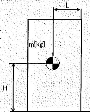
$C_H$  : 水平方向設計震度
