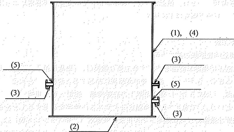
図-1 供給タンク，処理水タンク 概要図
