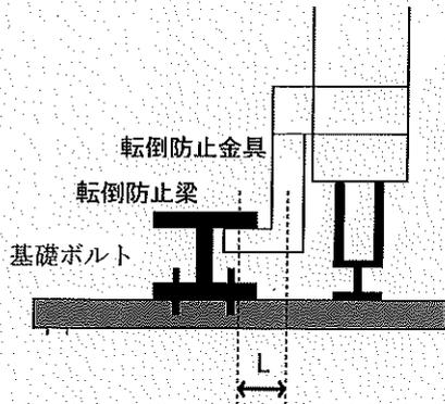
L : 転倒防止金具の中心軸と転倒防止梁
