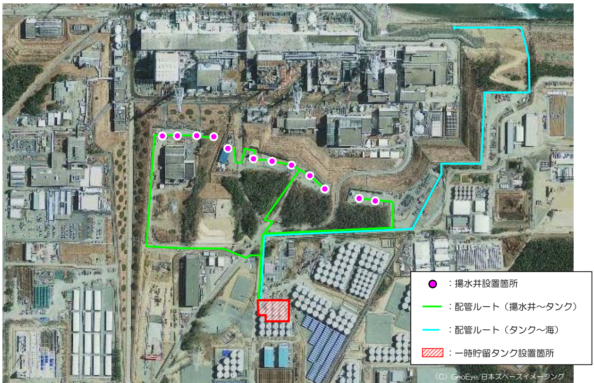
図2 地下水バイパスの設備
