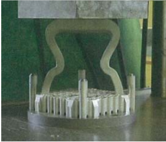
ハンドルを変形させる試験
