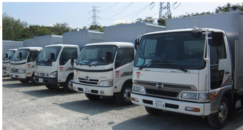
電源車の配備状況
