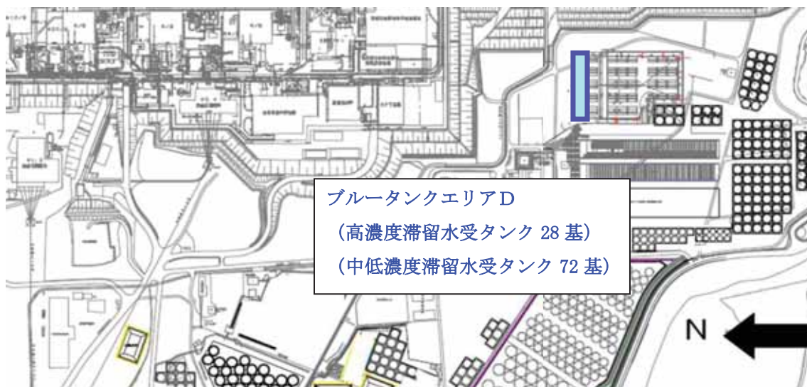
図-13 ブルータンクの仮置き場所
