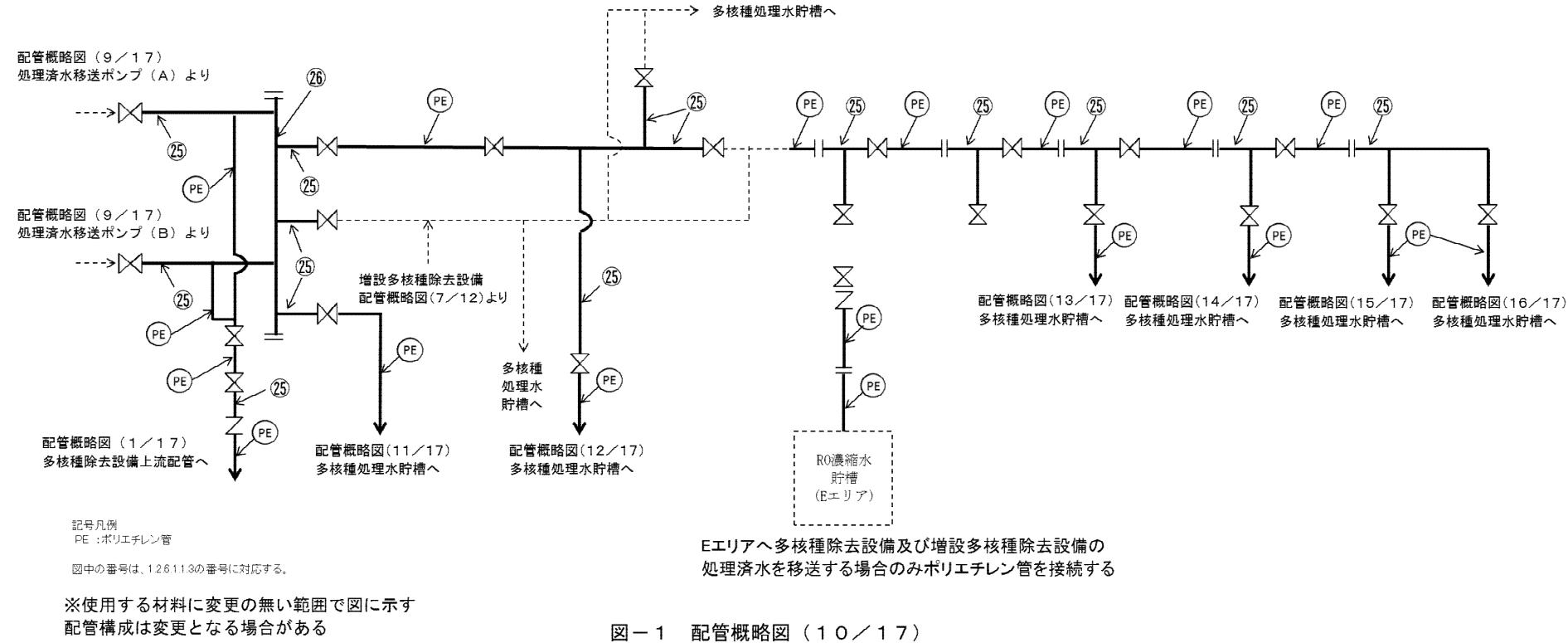
図-1 配管概略図 (10/17)
