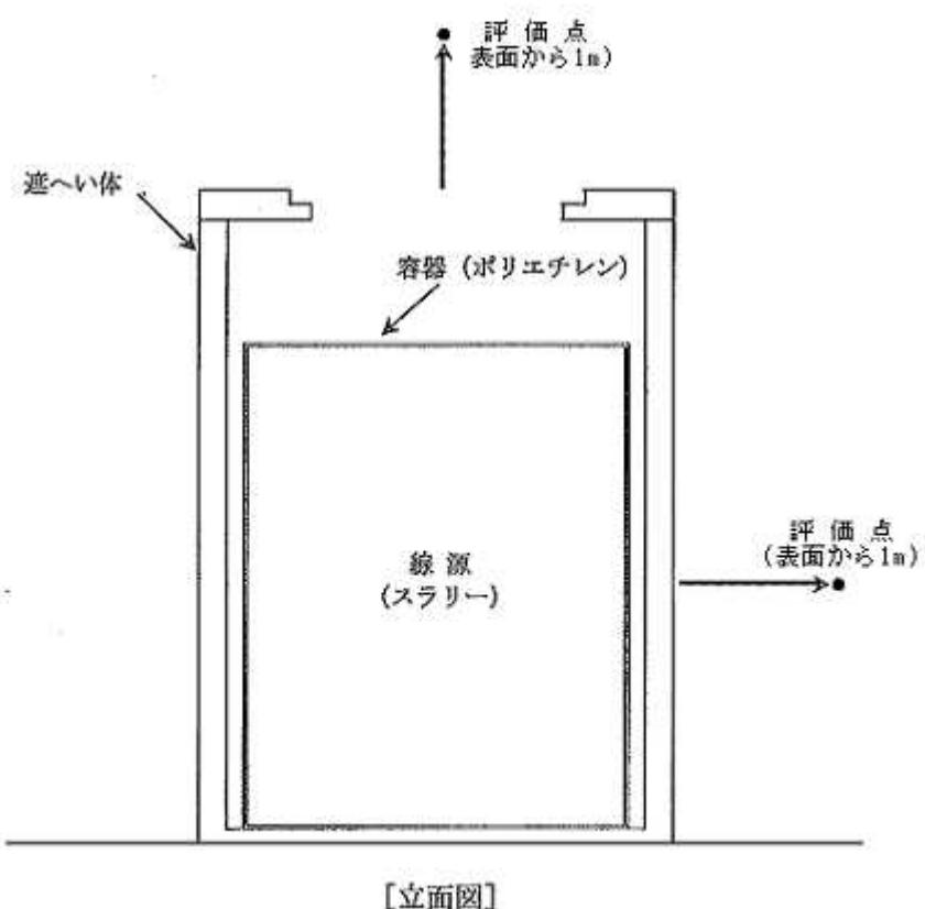
図1 スラリーを充填するHICの評価モデル
