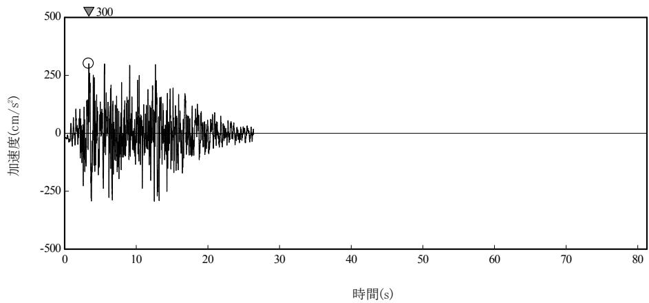
図-11 解放基盤表面位置における地震動の加速度波形（鉛直方向）
