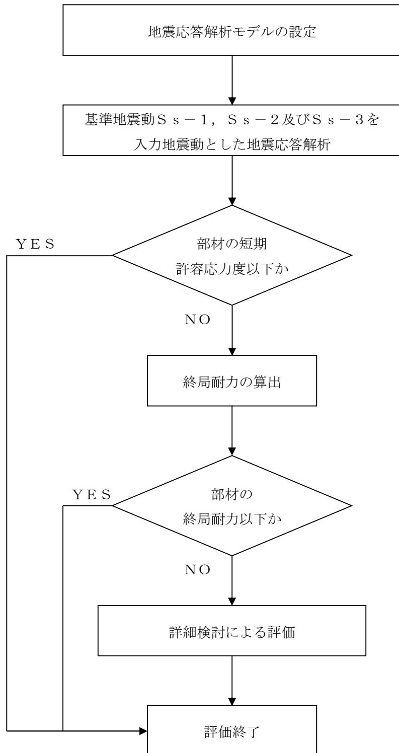
図-7 基準地震動  $S_s$  に対する建屋の耐震性評価手順
