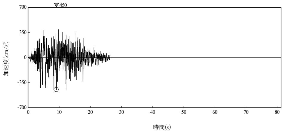
図-10 解放基盤表面位置における地震動の加速度波形（水平方向）
