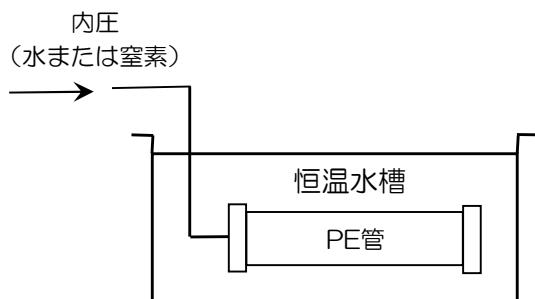
図1. 热間内圧クリープ試験の概念図
