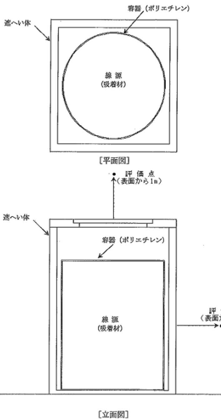
図2 吸着材を充填するHICの評価モデル
