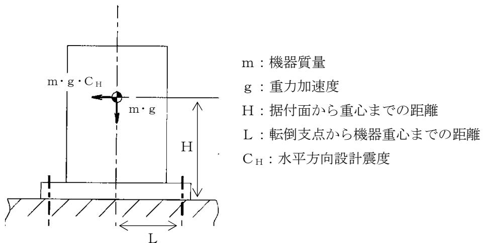
$$\text{地震による転倒モーメント} : M_1 = m \times g \times C_H \times H$$
