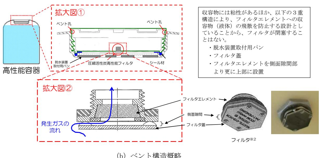
※1 ベント構造は、水素発生量に応じ2種類（①フィルタ2個、ベント孔16個 ②フィルタ13個、ベント孔32個）を使用することで、可燃限界に対して十分低い濃度を確保する。
