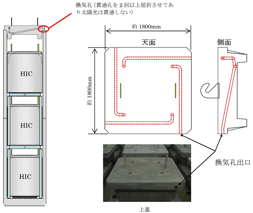
図5 一時保管施設（第三施設）ボックスカルパート内HIC収容概略
