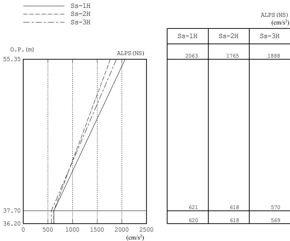
図-13 最大応答加速度 (NS 方向)
