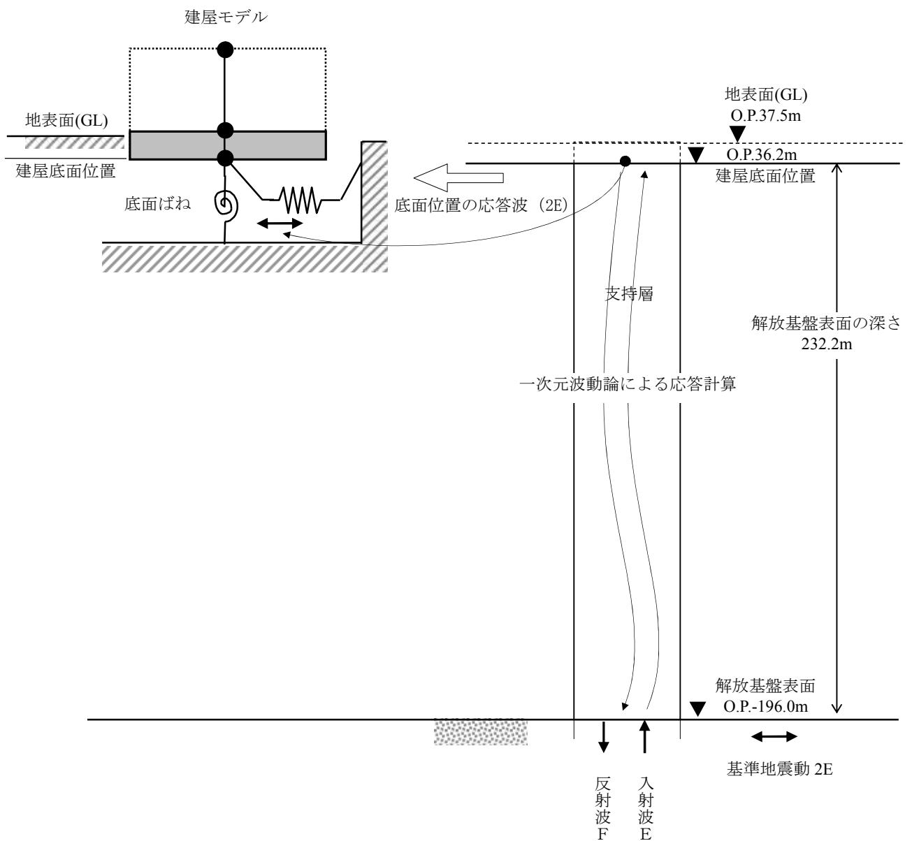
図-8 地震応答解析に用いる入力地震動の概念図（水平方向）
