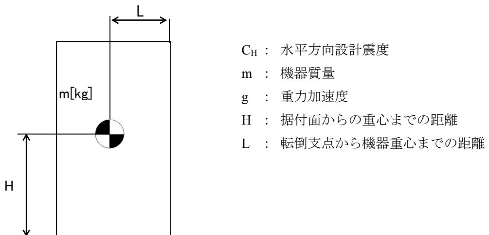
$$\text{地震による転倒モーメント} : M_1 = m \times g \times C_H \times H$$
