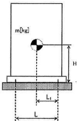
L : 基礎ボルト間の水平方向距離
