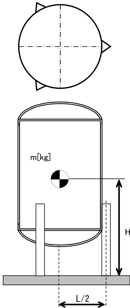
$L$  : 脚断面の図心の描く円の直径
