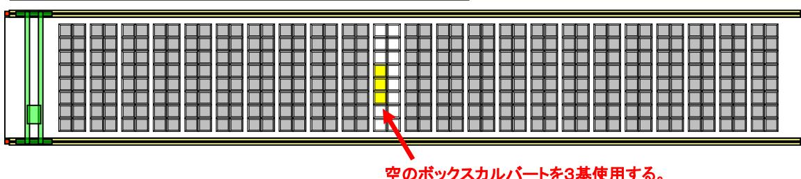
図1 保管中高性能容器内水抜き装置設置位置
