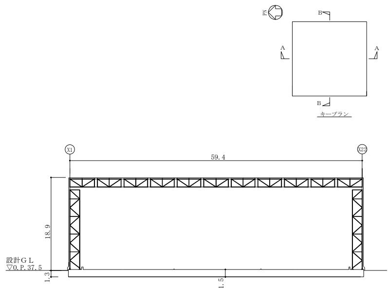
図-3 A-A断面図 (NS方向) (単位:m)
