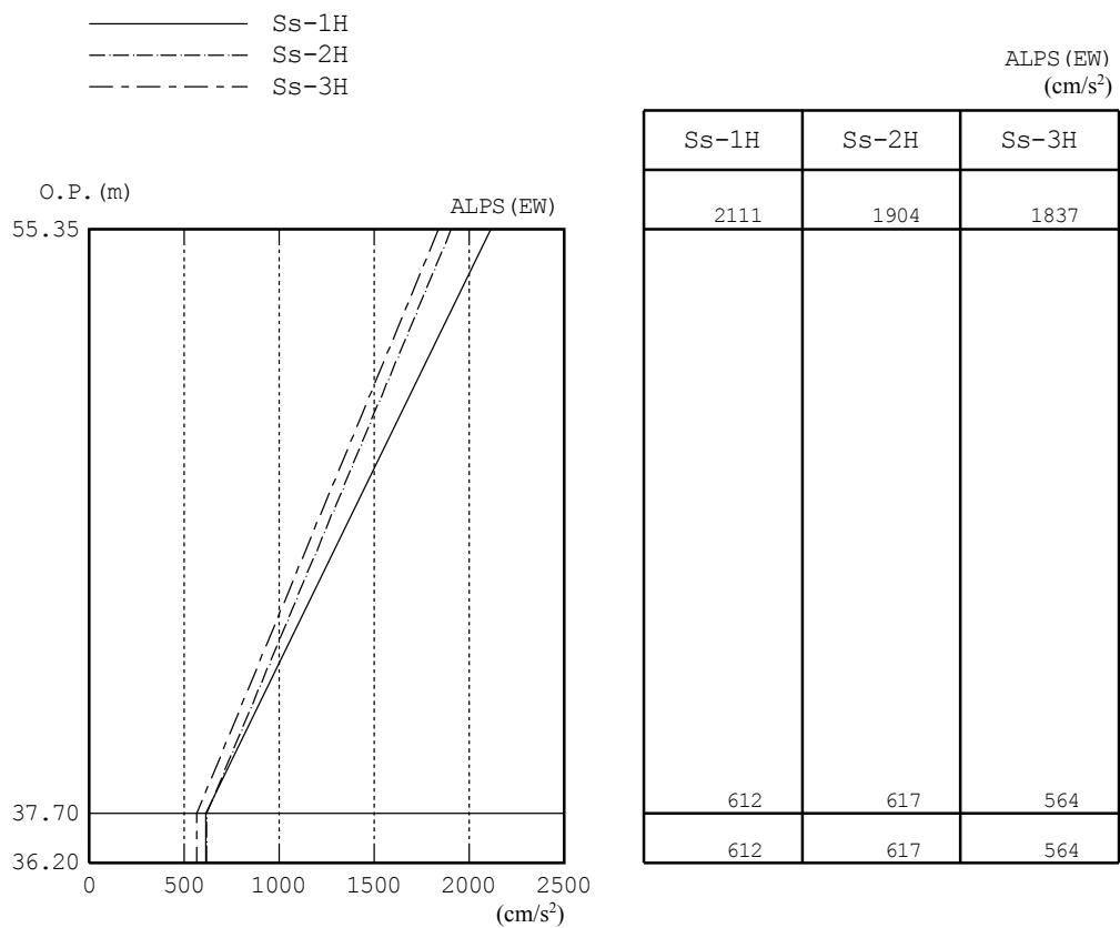
図-14 最大応答加速度 (EW 方向)
