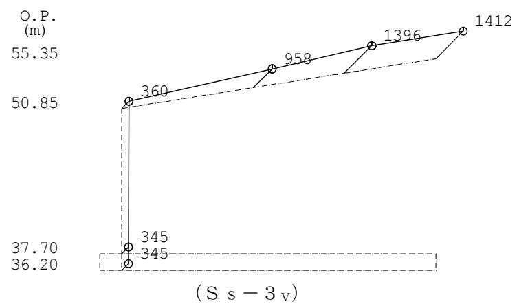
図-15 最大応答加速度（鉛直方向）
