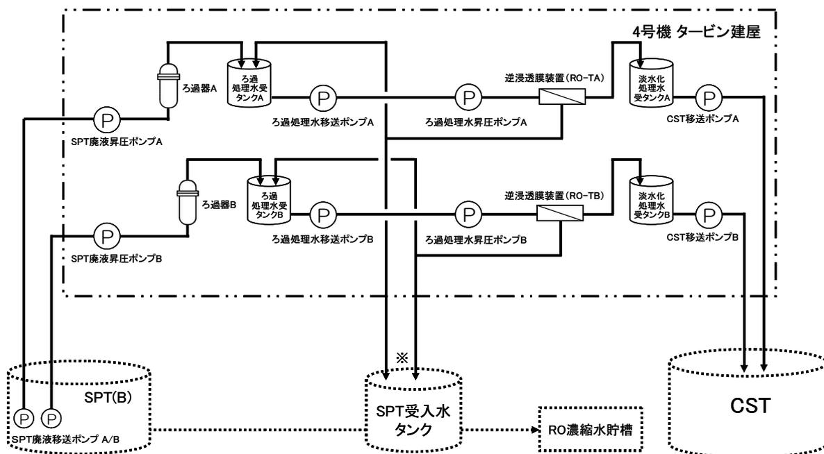
※： SPT受入水タンク接続管台は建屋内RO循環設備の範囲に含む。
