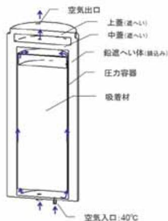
図1 吸着塔解析モデル（概念図）
