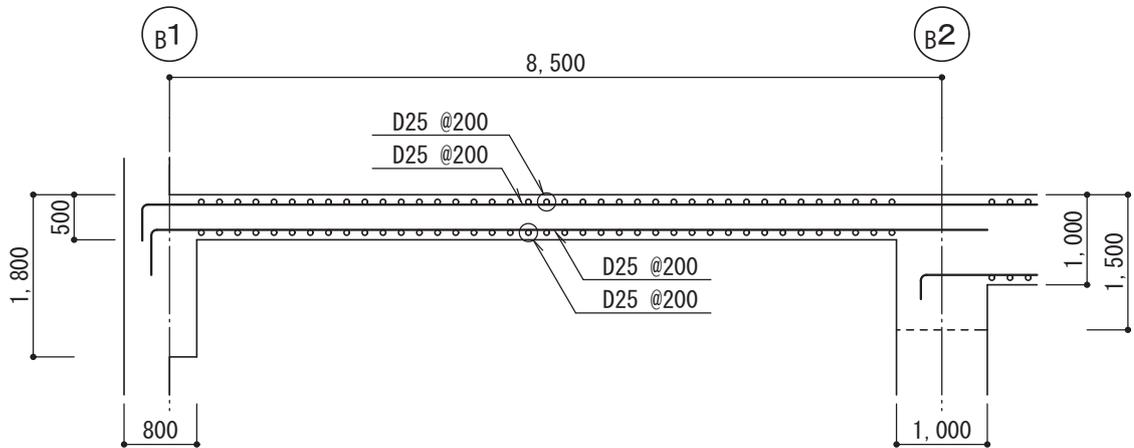
図 3-1 床スラブ配筋図 (単位: mm)
