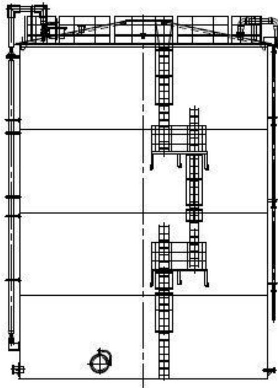
溶接型タンク概略図 (H4 南(1, 140m<sup>3</sup>))
