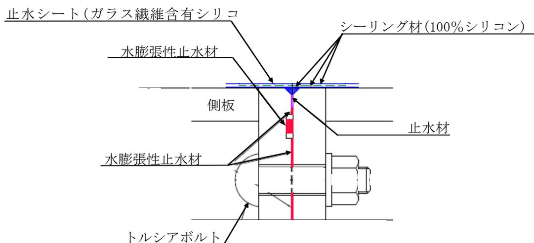
(3) 側板継手の止水構造 (周方向継手)
