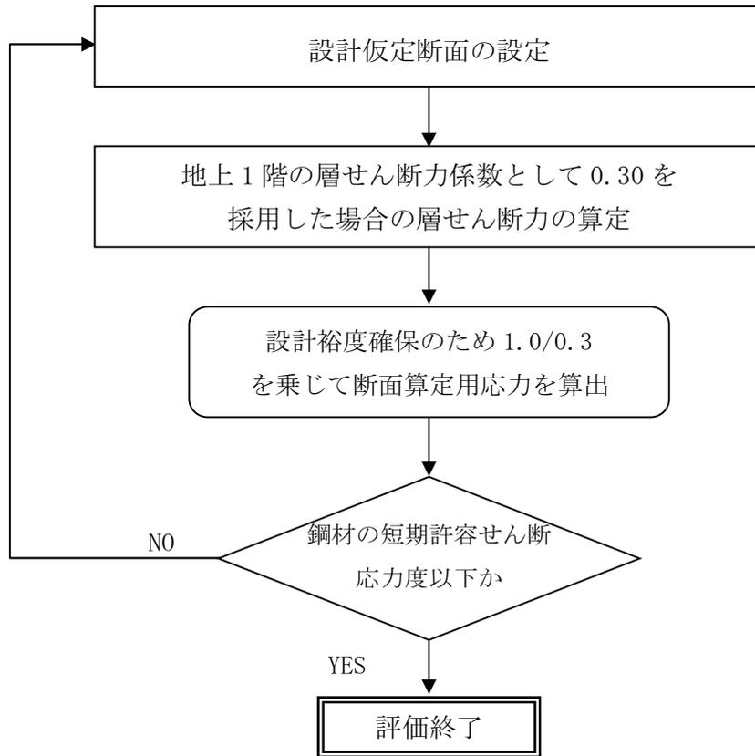
図-17 建屋の耐震安全性評価手順
