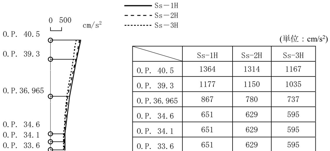
図-25 最大応答加速度 (EW 方向)
