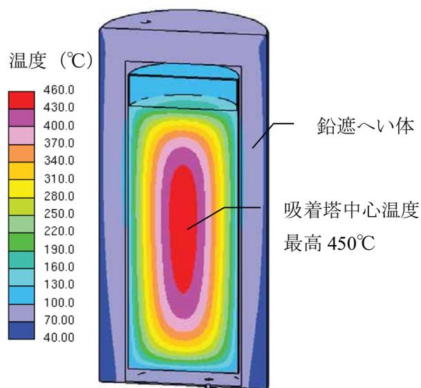
図-4 三次元解析による第二セシウム吸着装置吸着塔の温度分布
