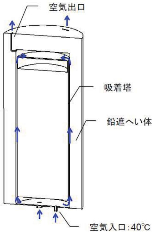
図-3 (TYPE-A) 同時吸着塔
