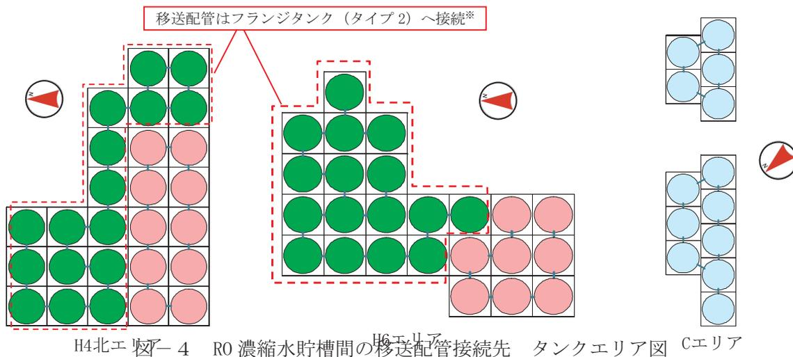
図4 RO濃縮水貯槽間の移送配管接続先
