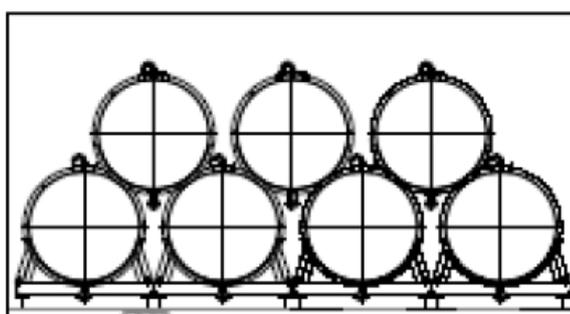
図-15 ブルータンクの仮置き状態
