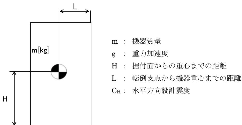
地震による転倒モーメント： $M_1$  [N・m] =  $m \times g \times C_H \times H$
