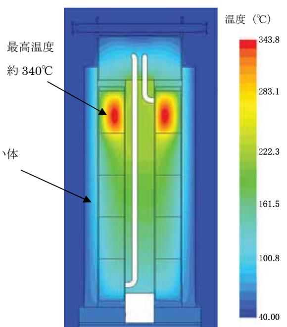
図-6 (TYPE-B) 三次元解析による
