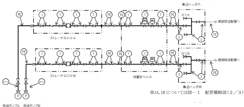
図－1 配管概略図（1／3）
