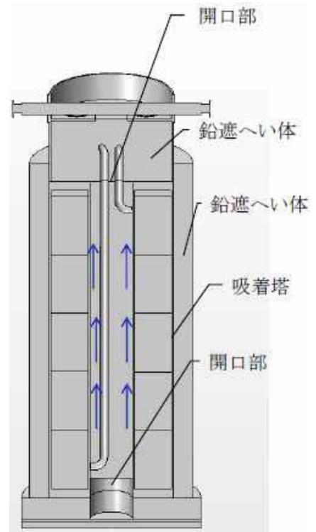
図-4 (TYPE-B) 同時吸着塔
