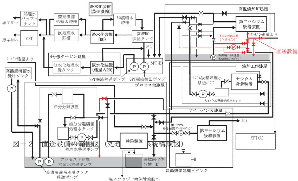
図-2 直送設備の範囲図（全体構成図）
