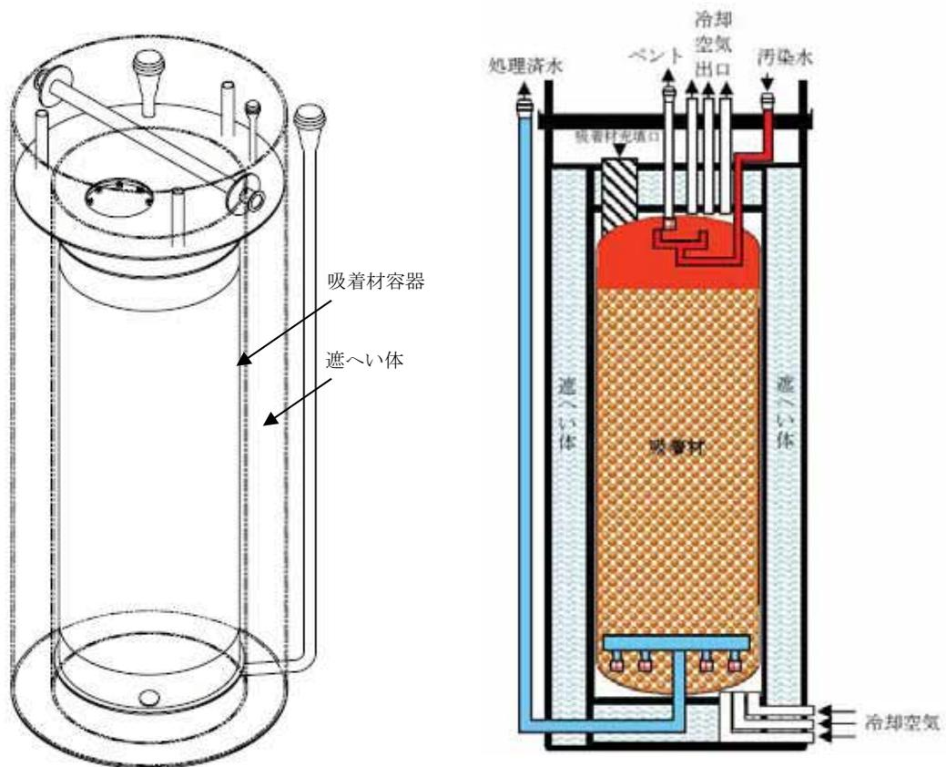
図－1（1／2） 同時吸着塔外形図及び概念図（TYPE-A）
