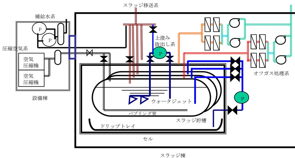
図-9 廃スラッジ一時保管施設概要図
