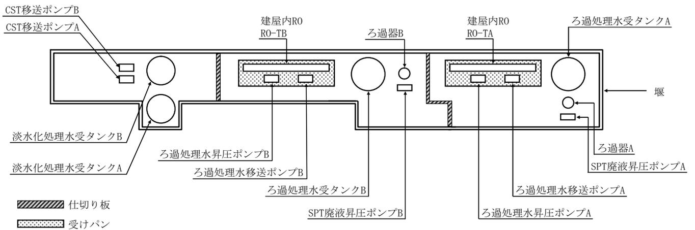
図-1 漏えい拡大防止 堰配置図
