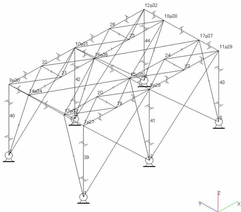
図-5 ディスクフィルタ解析モデル
