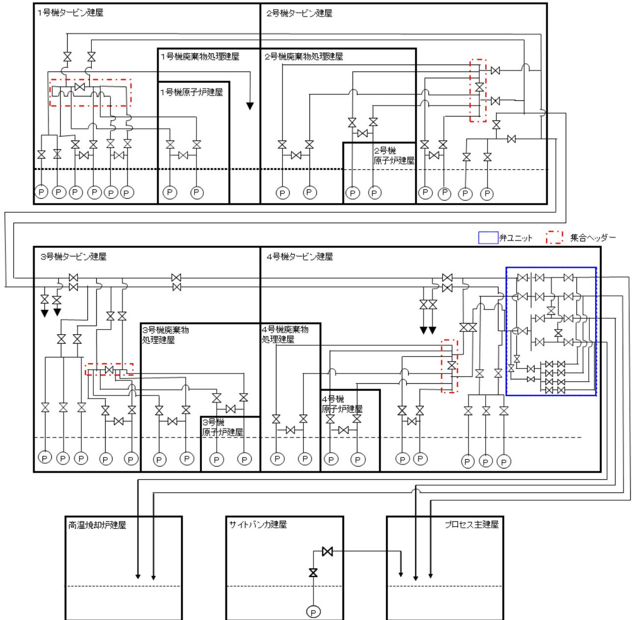
(b) 移送装置系統図概略図
