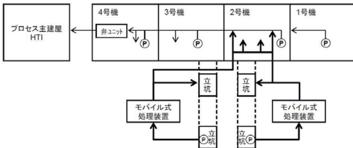
図1 モバイル式処理設備の系統概略図
