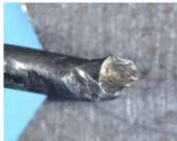
レーシングワイヤ破断面外観
