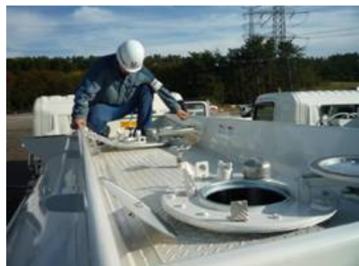
注入口ハッチ開放による内部確認
