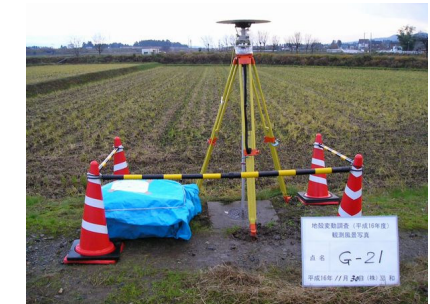
GPS アンテナ等の設置状況例
